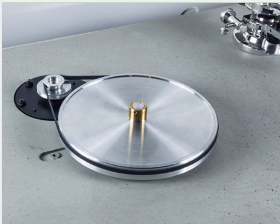
Ein antistatischer, polierter Gummiriemen verbindet den extrem geräuscharmen Motor (isoliert im Chassis untergebracht) mit dem Aluminium-Subteller
