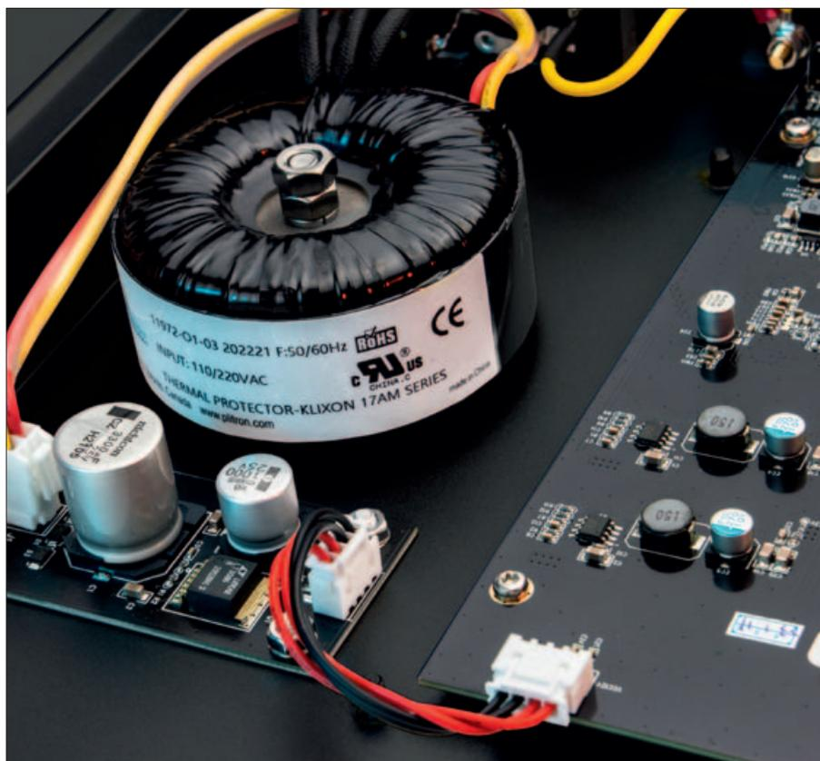
Herzstück Nr. 2: Das Linear-Netzteil mit dickem Ringkerntrafo (hier ist die Abschirmung für das Foto entfernt worden) war bisher den deutlich teureren Lumin-Geräten vorbehalten.
