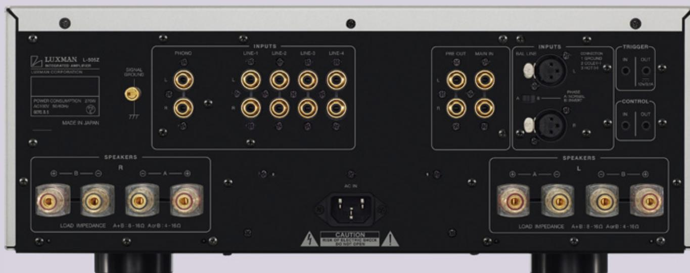
Der L-505Z kann als reine Vorstufe oder als reine Endstufe fungieren. Ein Extra-Port für Plattenspieler, wahlweise mit MM- oder MC-System
