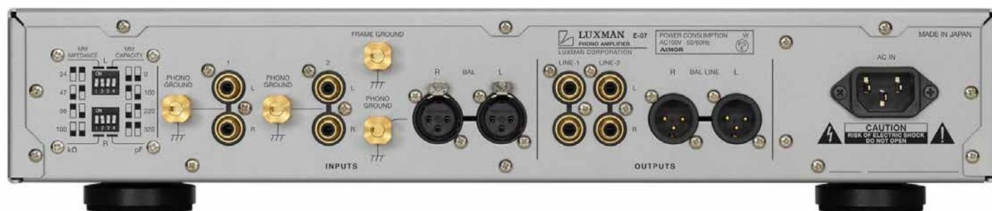
Während sich die wichtigsten Bedienelemente wie Eingangs- und Ausgangswahl, Hochpass- und Monoschalter auf der Vorderseite befinden (links), lassen sich rückseitig per DIP-Schalter weitere Einstellungen vornehmen.
