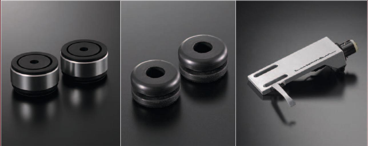
**BEIWERK:** Die höhenverstellbaren Füße (links) und die Dämpfungsringe (mitte) am und im Luxman PD-151 sollen Vibrationen aller Art von der Abtastnadel fernhalten. Luxman nennt die Gummimischung „High Damping Rubber“ (HDR) und schreibt ihr eine Dämpfung von über 98 Prozent unabhängig von Motordrehzahl und Außentemperatur zu. Zur Aufnahme von Halbzoll-Tonabnehmern dient die abnehmbare Headshell (rechts) aus einer Magnesium-Legierung. Sie erleichtert Systemwechsel und -justage ganz erheblich.
