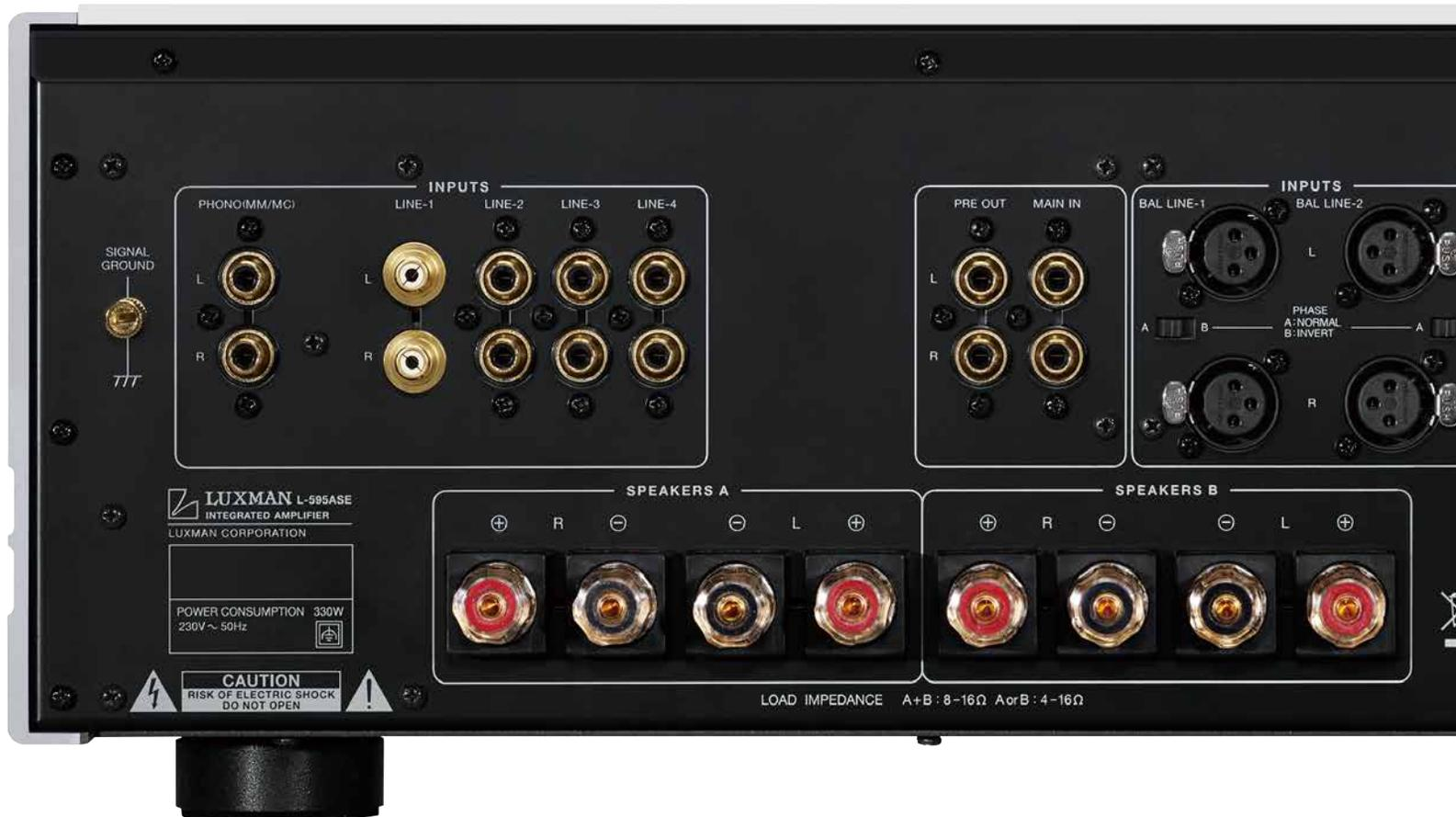
Das übersichtliche Anschlussfeld bietet ausreichende Möglichkeiten: Die ersten beiden der insgesamt fünf Line-Ins lassen sich zwischen RCA und XLR umschalten – der L-595A bietet damit faktisch sieben Eingänge inklusive eines superben MM/MC-Phono-Pres. Zusätzlich gibt's einen Pre-Out sowie den Endstufeneingang.
