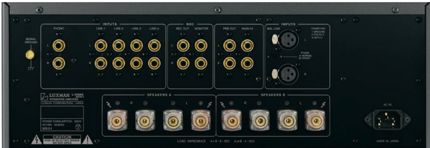
Selten anzutreffen, aber praktisch: Die symmetrischen Hochpegel-Eingänge bieten einen Umschalter für die absolute Phase. Wer eine Installation korrekt vornehmen will, sollte mit einer Test-CD für jeden Eingang die Phasenlage prüfen.
