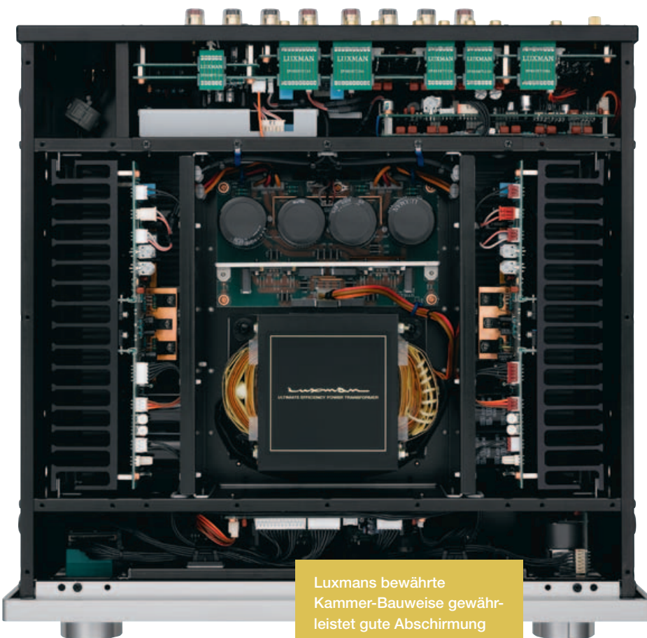
Die diskret aufgebaute A-Endstufe kann an den Endtransistor-Paaren mit kupfernen Stromschienen aufwarten.
