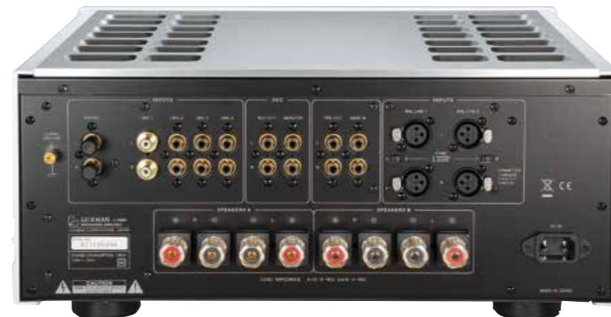
▲ Phono MM/MC in gewohnt hoher Qualität, zudem zwei symmetrische Hochpegeleingänge und auffrennbare Verstärkerzüge zeichnen das Luxman-Flaggschiff aus – neben exklusiver Verarbeitung.
