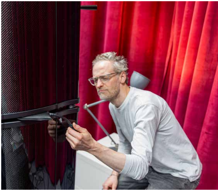
Luke Milnes in Aktion: Mit einer Art Blasebalg (links) wird ein Abstand zwischen den beiden Teilen der Omnium hergestellt. Ohne dieses Hilfsmittel kann man die innenliegende Verkabelung nicht einstecken. Im rechten Bild erkennen Sie die beiden Rollplatten, die bei Auslieferung an der Omnium angebracht sind. Die Spikes sind im Foto noch „ganz nach oben“ geschraubt. Senkt man sie ab, kann man die Rollen einfach rausnehmen – extrem fein gelöst, das Ganze.
