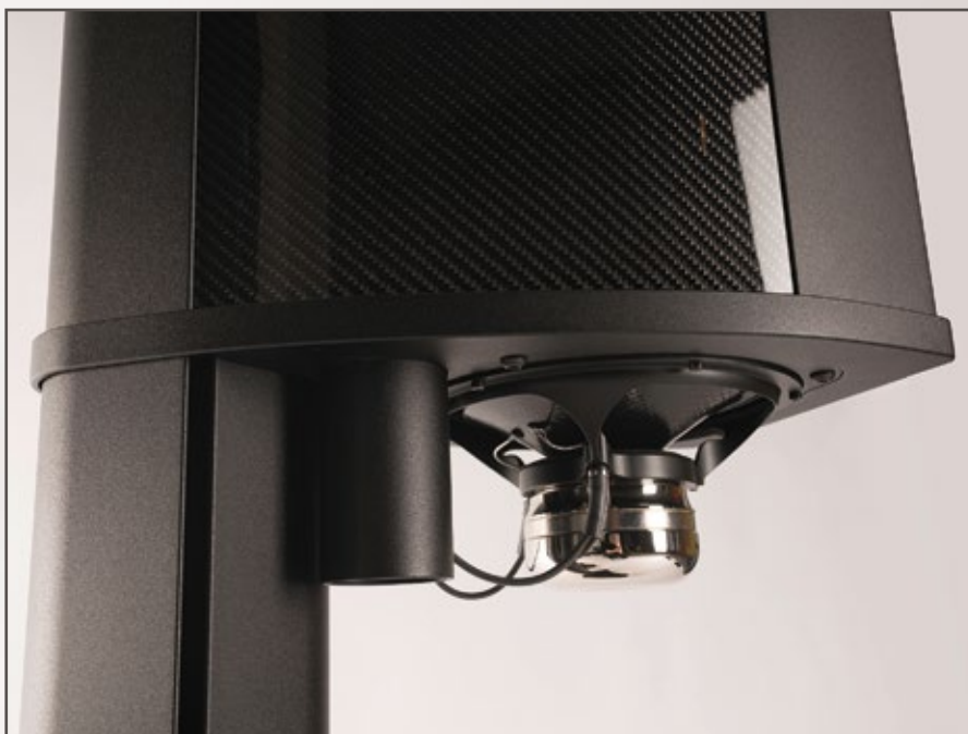
Die Tieftöner der Wilson Benesch Lautsprecher arbeiten nach dem isobarischen Prinzip. Bedeutet: die Treiber sind gegensätzlich verpolt und zueinander verschraubt
